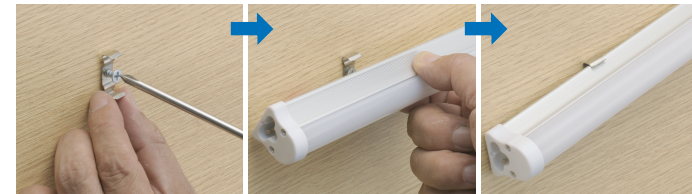
二カ所に金具を取付け、本体をはめ込むだけ
